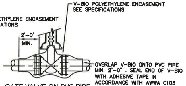
**GATE VALVE ON PVC PIPE**
