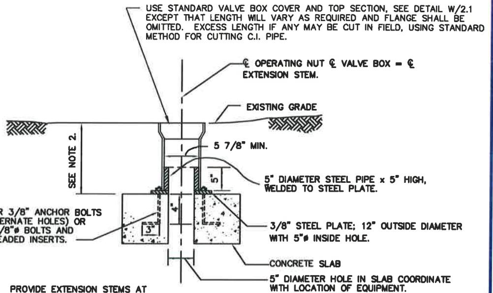
**VALVE BOX SLAB OPENING**
